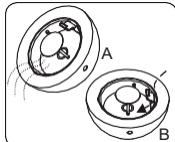
Wasser nicht über die Belüftungsöffnung B (links) abgießen, da sonst die Gefahr besteht, dass Wasser in das Gerät eindringt. Dies könnte zu Schäden an den Bauteilen und zu Betriebsausfall führen.
