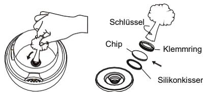
Klemmring, wie in der obigen Zeichnung gezeigt gegen den Uhrzeigersinn drehen, um das Fach zu öffnen. Alten Chip entnehmen und neuen Chip mit der Vorderseite nach oben auf die Feder und das Silikonkissen legen. Zum Abschluss den Klemmring im Uhrzeigersinn wieder festdrehen.
